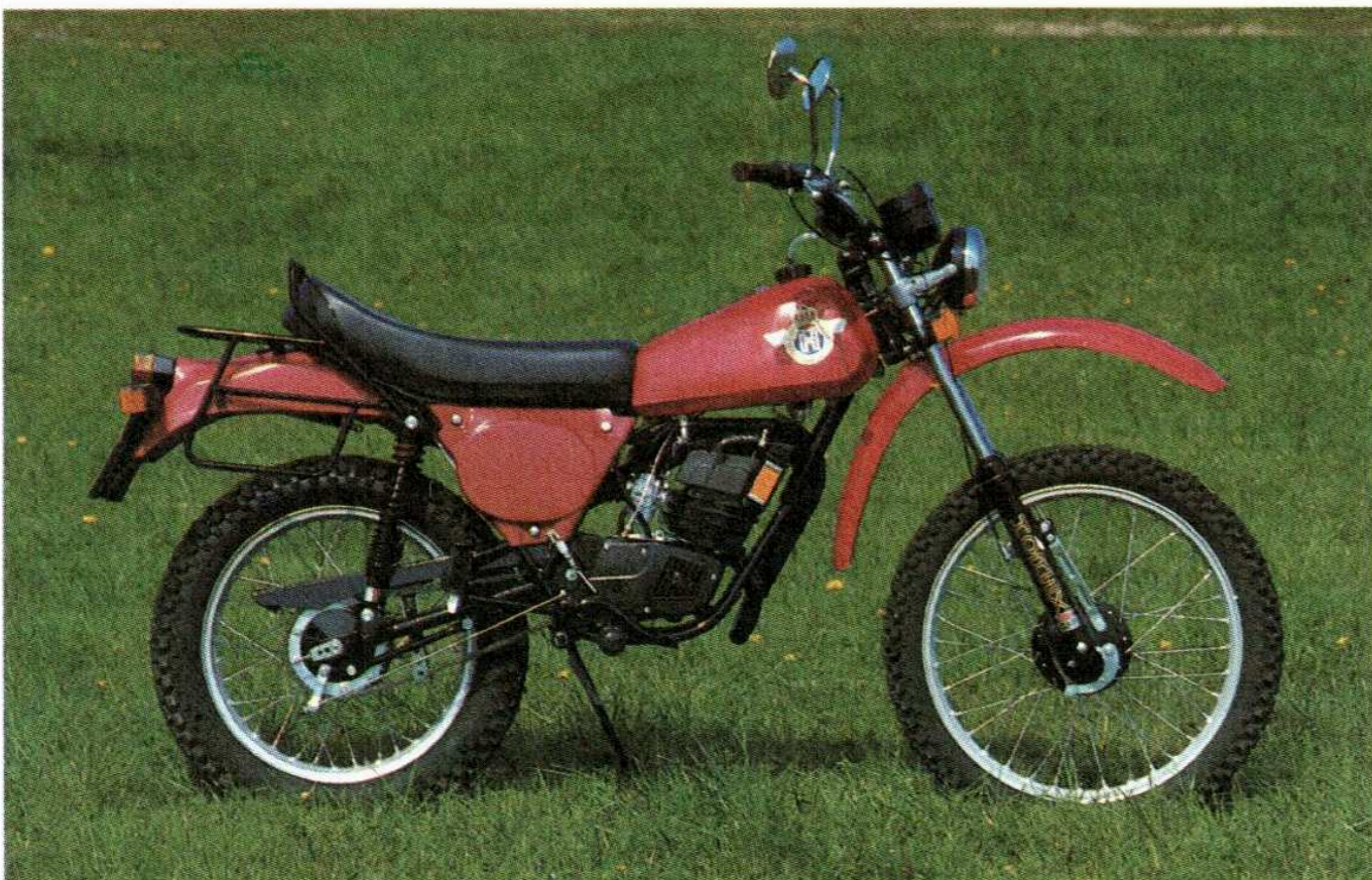
Horex Rebell TC 80: Deutsche Enduro mit Sachs-Motor, gebaut in Portugal bei Casal
