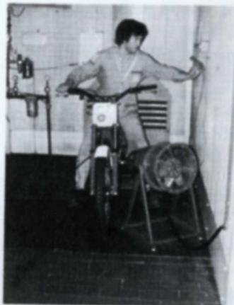
Test auf dem Rollenprüfstand
