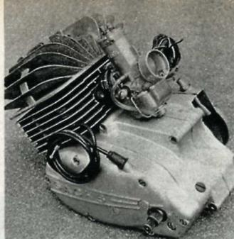
**Oben: Großer 32er-Vergaser am GP-Motor. Bild rechts: Zwei 22er-Vergaser auf siamesischem Ansaugstutzen. Zuerst öffnet der linke, der rechte folgt nach halber Strecke**
